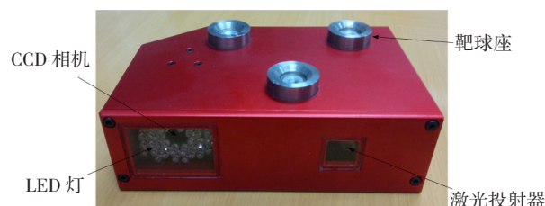
图5 线结构光视觉测量传感器 Fig.5 Linear structural light vision sensor
